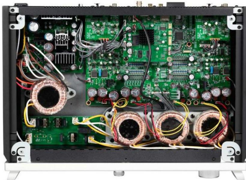
Du siehst die Stufe vor lauter Trafos nicht: Mehrfachwicklung? Pah, für Einsteiger – Teac verbaut stattdessen lieber mehrere Trafos, je einen für jede Sektion (Analog/Digital) sowie jeden Kanal der analogen Signalführung des Streaming-Vorverstärkers. Angesichts der kompakten Gehäusemaße der reinste Luxus.
