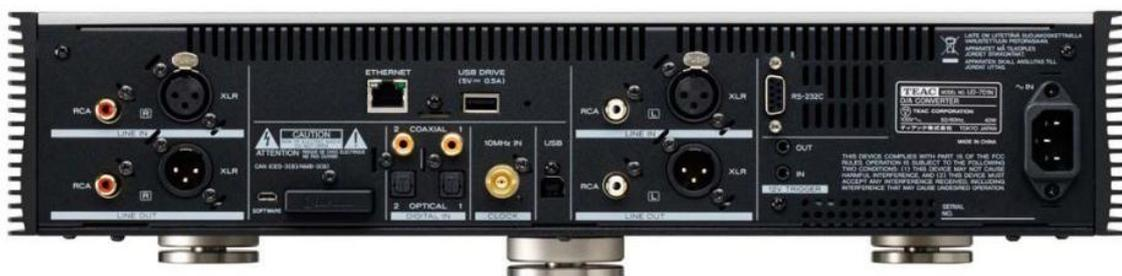
Die Vorstufe lässt sich über einen vergoldeten BNC-Anschluss (mittig am Gerät) von einer externen 10 MHz-Clock takten. Der Hersteller kann (und will) seine gedankliche Nähe zu Esoteric nicht verheimlichen ...
