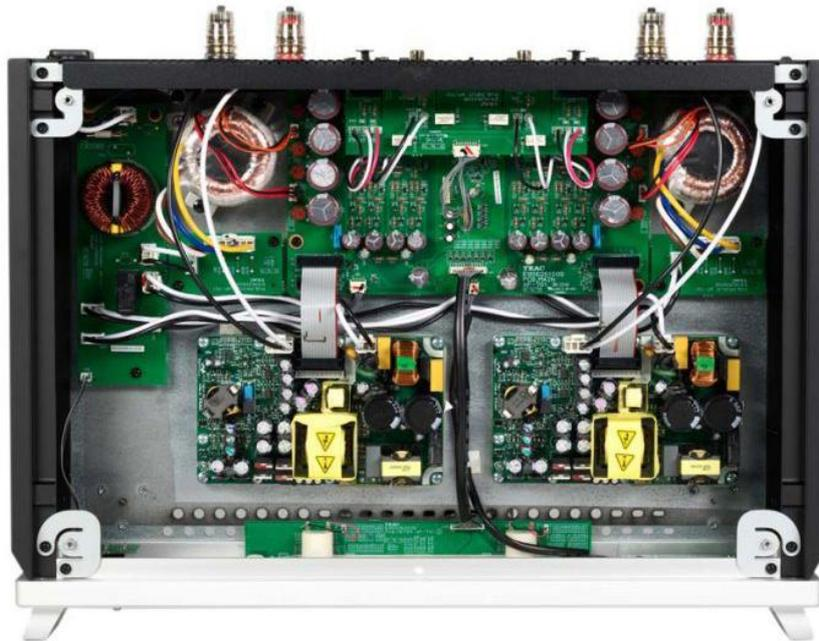
Man beachte, dass bei der Endstufe nicht nur die Verstärkermodule (unten), sondern auch die Eingangssektion penibel Kanalgetrennt aufgebaut wurden.
